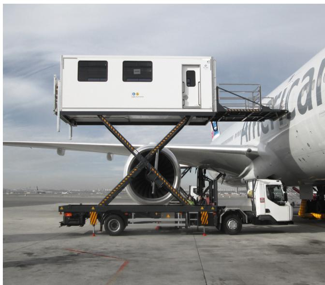
Todos los vehículos Ambulift están contruidos con un **sistema de elevación y gatos estabilizadores**. Además, cuentan con una carga útil que, según su configuración, puede comprender entre los 1500Kg y los 4500Kg.
